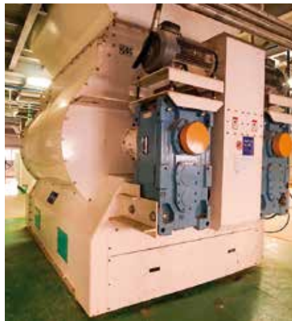
High speed 5-tonne, twin-shaft paddle mixer, mixing time 3 minutes, CV below 5% เครื่องผสมแบบ 2 แกน ความจุ 5 ตัน รอบการผสม 3 นาที ค่า CV ต่ำกว่า 5%
